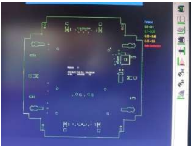
Abb.: 10 dxf-Stanzabgleich mit Toleranzbereich
