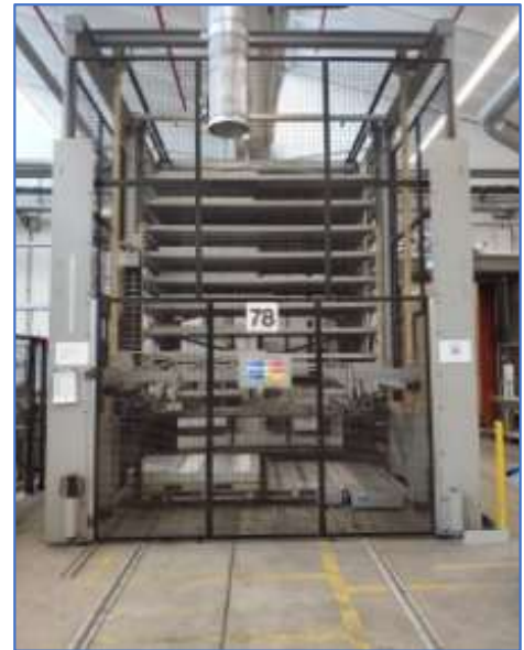
Abb.: 3 Materialturm mit 9 Ebenen
