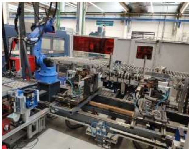
Abb.: 8 Schweißzelle mit Roboterarm und Spannvorrichtung
