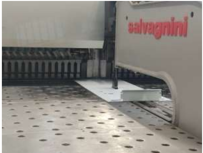
Abb.: 5 Biegeautomat P4 mit Platine
