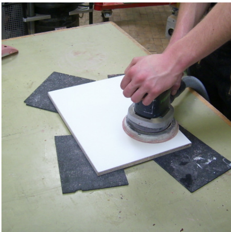
Zwischenschliff: Körnung 280 bis 320
